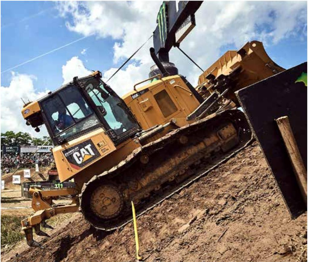
**Ein Bagger begradigt Spurlinien am Zielsprung. Hinter ihm ist ein Gerät angebracht, das den plattgefahrenen Boden auflockert.**
